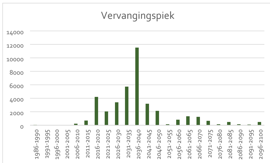
Figuur 3. In deze grafiek is weergegeven hoeveel oeverbescherming (in meter) vervangen dient te worden gebaseerd op theoretische levensduur.
